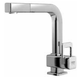
35121.1.004.320.1 Spültischmischer mit Auszugbrause Patrone Quattro-G Ausladung 225 mm Schwenkauslauf Sink single-lever mixer with handspray cartridge Quattro-G spout reach 225 mm with swivel spout Mitigeur d'évier avec douchette cartouche Quattro-G saillie 225 mm goulot orientable Keukenmengkraan met uittrekbare handdouches keramische kardoos Quattro-G sprong 225 mm draaibare uitloop
